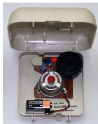
Ionizacijski javljalnik požara z virom sevanja ^{241}\text{Am}
